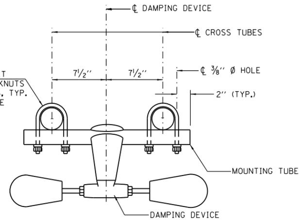
TRUSS DAMPING DEVICE CONNECTION DETAIL
