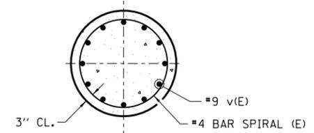
**SECTION A-A (TYPICAL FOR 4 SHAFTS)**
