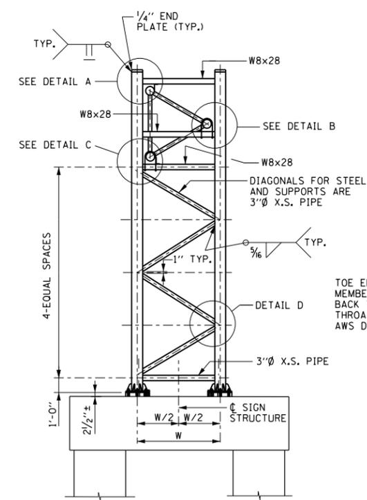
TYPICAL END SUPPORT ELEVATION
