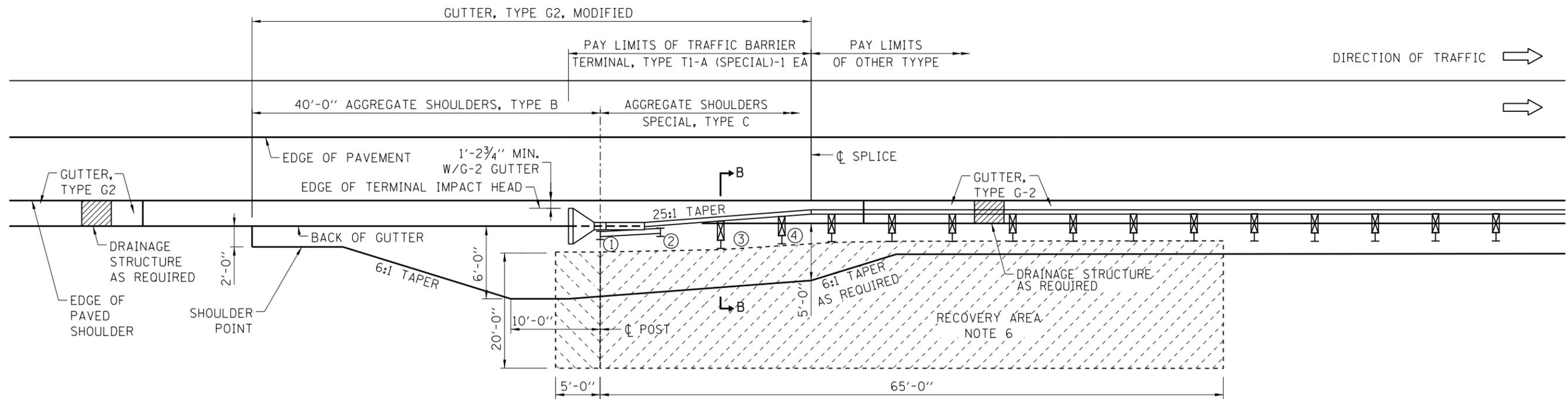
SHOULDER WIDENING TRANSITION-WITH GUTTER, TYPE G-2
