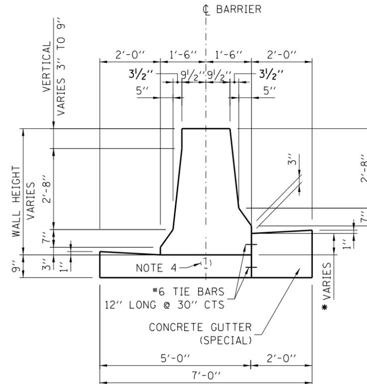
CONCRETE BARRIER, DOUBLE FACE, VARIABLE HEIGHT
