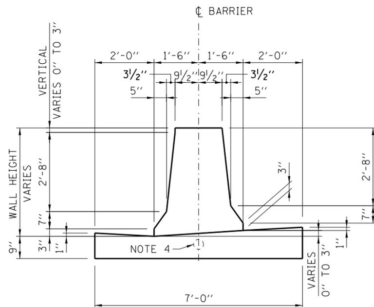
CONCRETE BARRIER, DOUBLE FACE, VARIABLE HEIGHT
