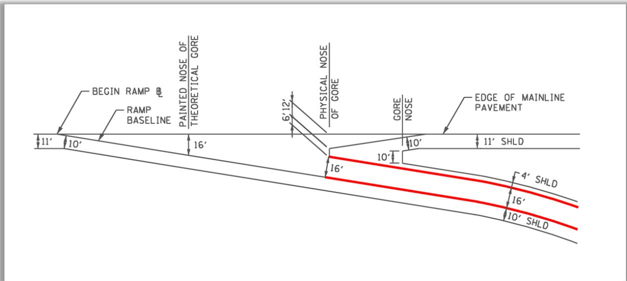
RDC FIGURE 5 TYPICAL EXIT RAMP TERMINAL
