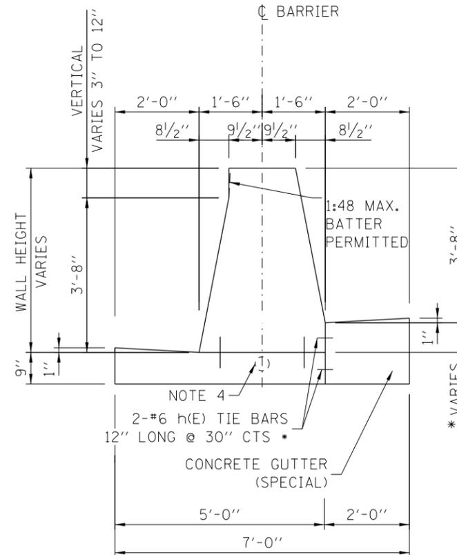
CONCRETE BARRIER, DOUBLE FACE, VARIABLE HEIGHT
