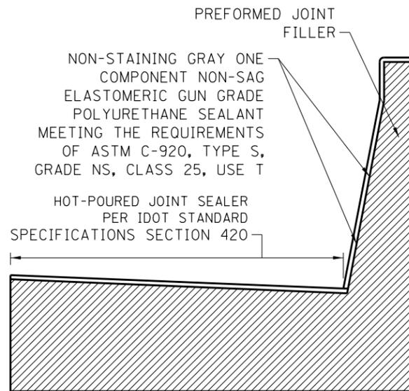
SINGLE FACE 54" BARRIER EXPANSION JOINT SECTION B-B
