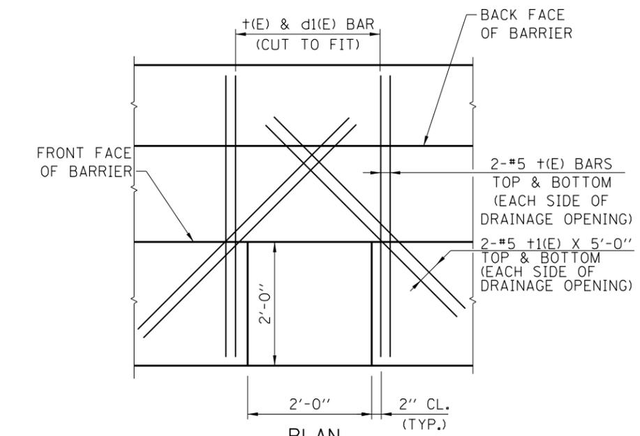
REINFORCEMENT AROUND DRAINAGE STRUCTURE
