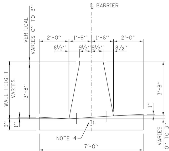
CONCRETE BARRIER, DOUBLE FACE, VARIABLE HEIGHT
