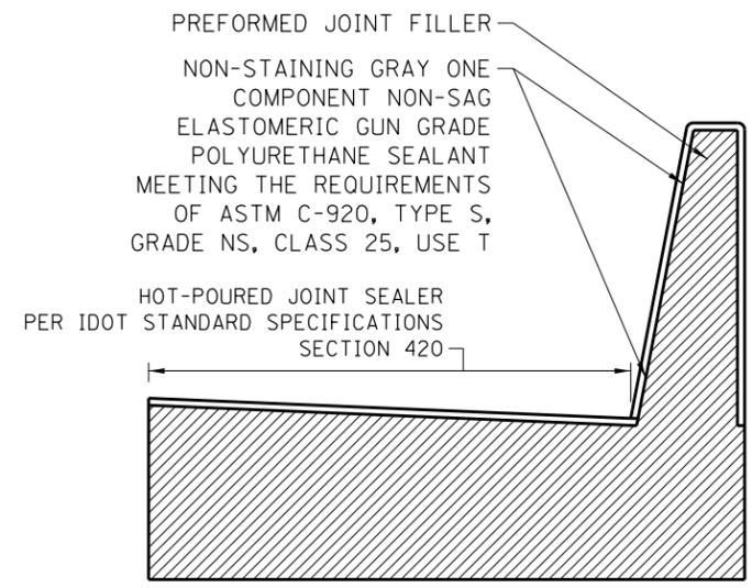
SINGLE FACE 44" BARRIER EXPANSION JOINT SECTION B-B
