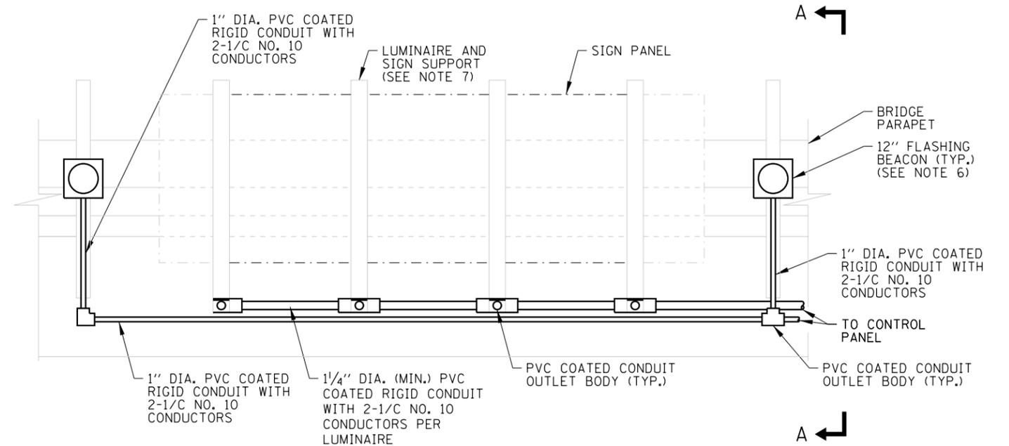
**TYPICAL FRONT ELEVATION WITH FLASHING BEACON**
