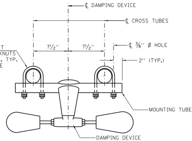
TRUSS DAMPING DEVICE CONNECTION DETAIL
